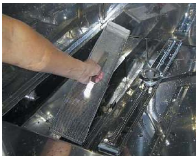
1: Sjekk og rengjør filtre og siler.
