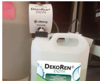
3: Sjekk stigerør og kanne på vaskemiddel og tørremiddel. Husk å sjekke at det er kjemi i kannen.
