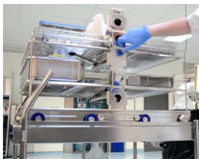
2: Vaskearmen må rotere fritt og klappeventiler må fungere.
