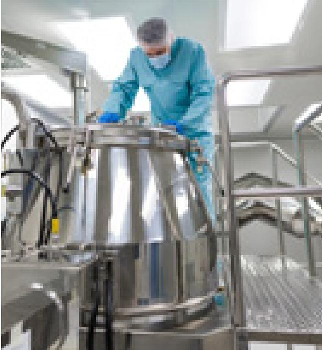
Il est facile de nettoyer une surface horizontale, mais le nettoyage devient difficile pour les surfaces verticales et les équipements sans NEP en utilisant les méthodes traditionnelles de nettoyage. Par conséquent, ces surfaces sont souvent négligées ou partiellement nettoyées. Les techniques de nettoyage par mousse/gel à basse pression proposées par Diversey vous apportent un certain nombre d'avantages.
